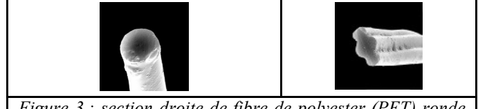
Figure 3 : section droite de fibre de polyester (PET) ronde (à gauche) et Coolmax® (à droite).
